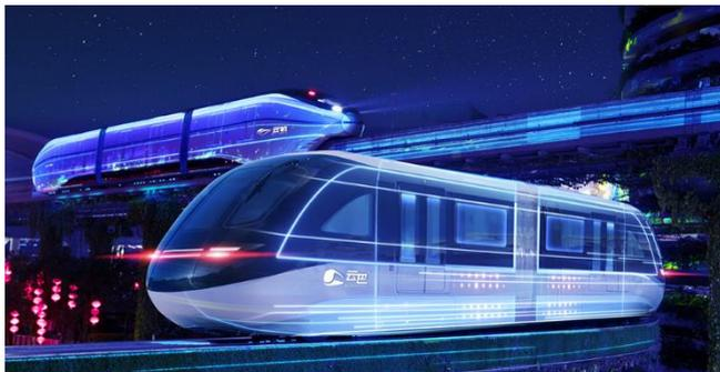
相當於歐盟和美國的人口總和，每年還在以 2000 多萬規模的速度遞增。過去十幾年來，我國城市汽車保有量年均增速高達 15%，城鎮道路里程增速僅為 2%。“兩化”疊加帶來了交通擁堵、空氣污染等一系列社會問題。憑藉在電子、汽車、新能源領域豐富積累的領先技術，比亞迪打造出中運量跨坐式單軌雲軌和小運量雲巴等軌道交通解決方案，有利於城市打造地下、地面和空中的立體化交通網絡。「雲巴」採用全鋁車體輕量化設計，通過車載動力電池供電，是一款純電推動的列車，採用橡膠輪胎在專用高架軌道行駛，最小轉彎半徑僅為 15 米，最大坡度可達 12%。自 2021 年 4 月起，先後在重慶、深圳、長沙等大城市開通「雲巴」路線，推出以來協助多個城市解決交通的問題。
